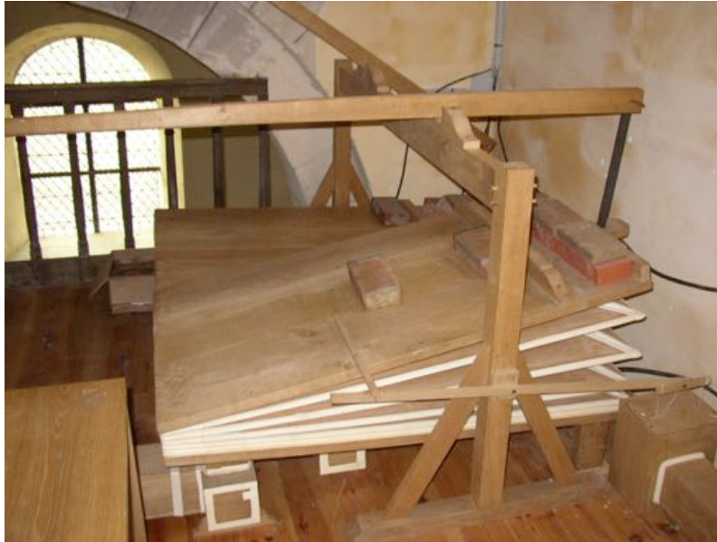
Vraux – Soufflet cunéiforme
